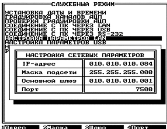
Рисунок 30 – Окно настройки сетевых параметров
