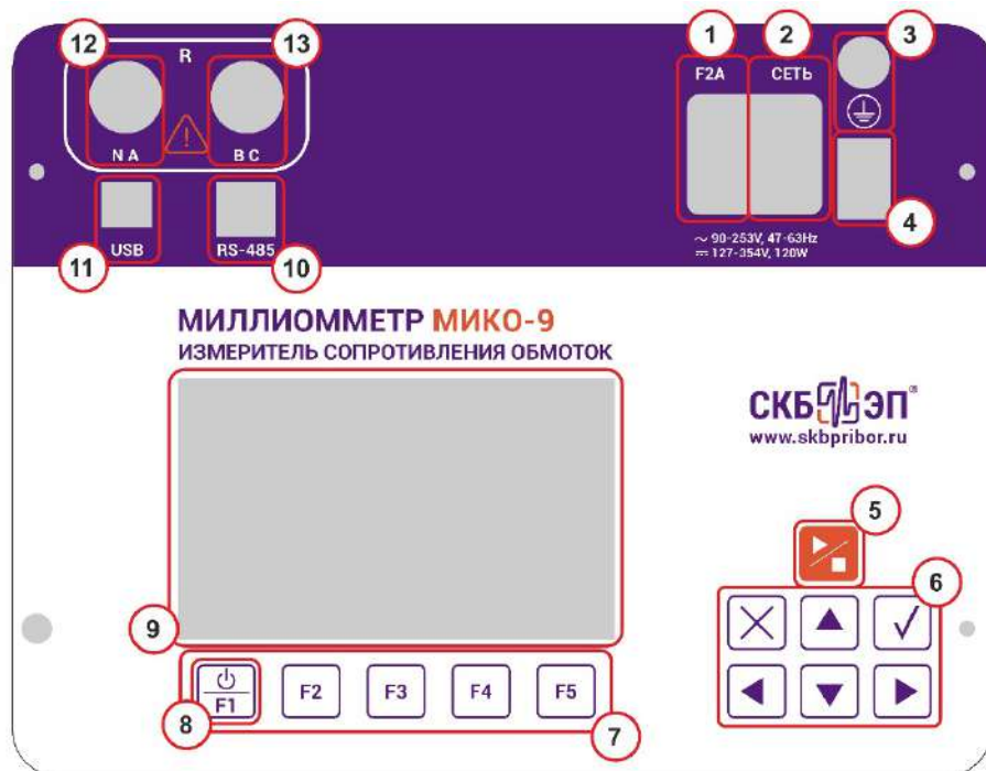
Рисунок 1 – Органы управления и разъемы МИКО-9(А)
