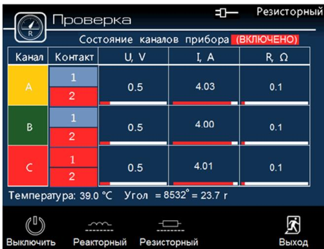
Рисунок 25 – Окно «Проверка резисторных устройств РПН в замедленном режиме» во включенном состоянии
