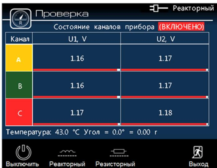
Рисунок 33 - Окно проверки измерительных каналов
