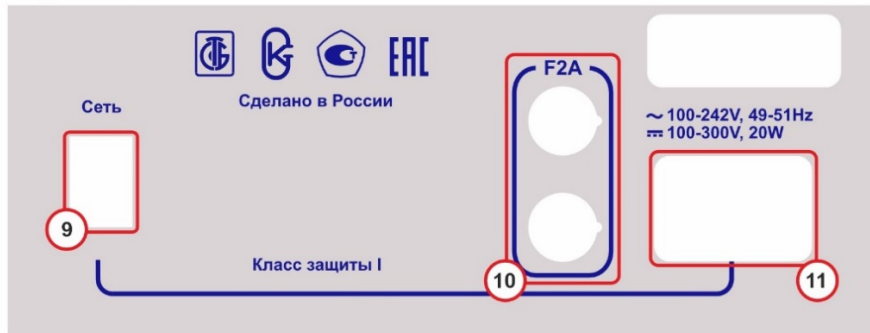
Рисунок 1 - Расположение разъемов, органов управления и индикации Таблица 2 – Органы управления и разъемы
