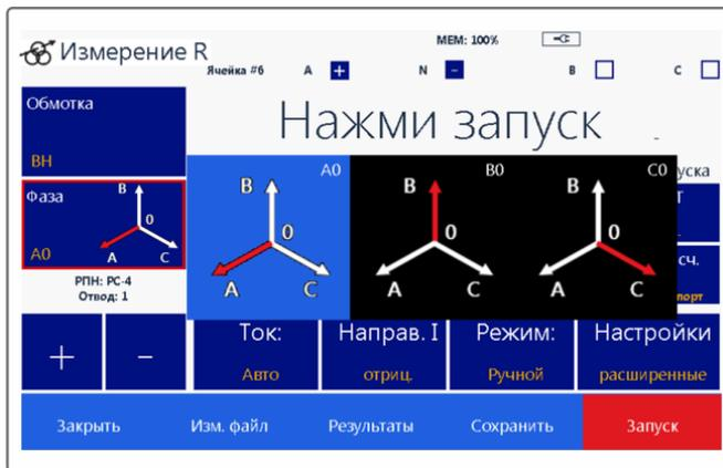
Рисунок 23 – Окно «Измерения R» объекта «Силовой трансформатор». Меню выбора фазы.
