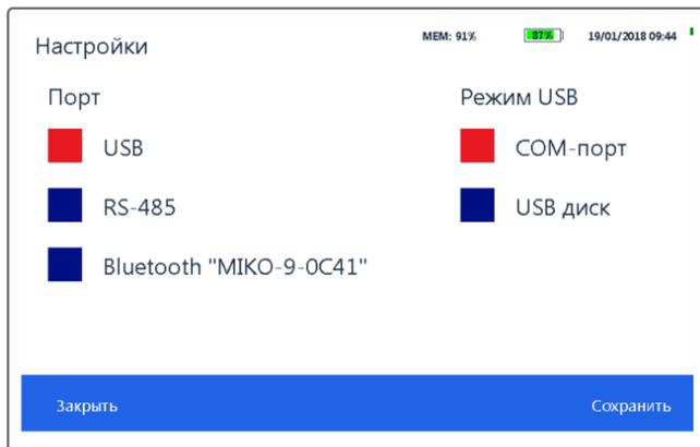
Рисунок 55 – Окно настроек связи прибора с ПК
