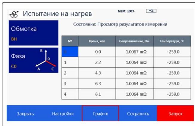
Рисунок 35 – Таблица результатов теста «Испытание на нагрев»
