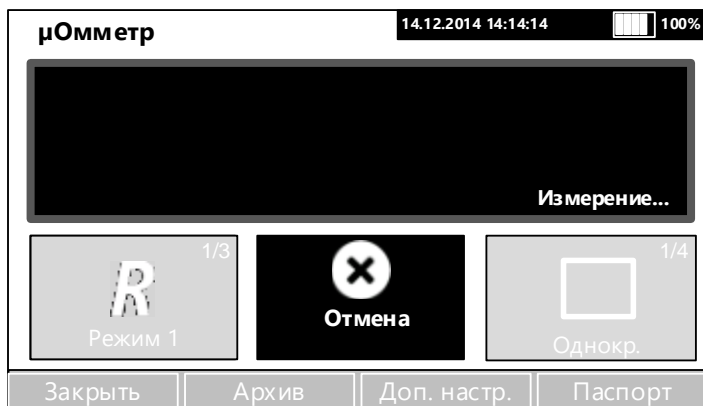
Рисунок 11 – Окно измерений. Проведение измерения
