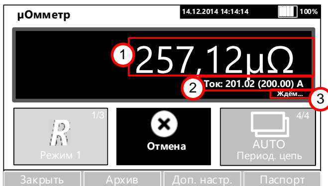
Рисунок 14 – Окно измерений. Результат измерения
