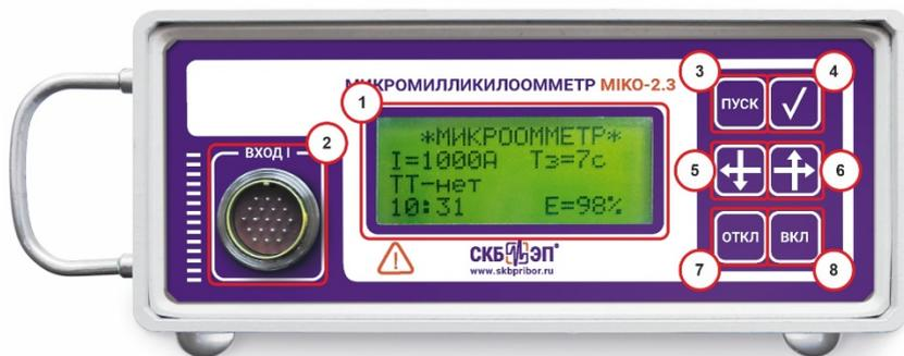
Рисунок 1 - Расположение разъемов и органов управления. Передняя панель
