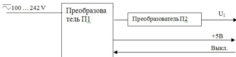
Рисунок 7 - Структурная схема зарядного устройства ЗУ-1А
