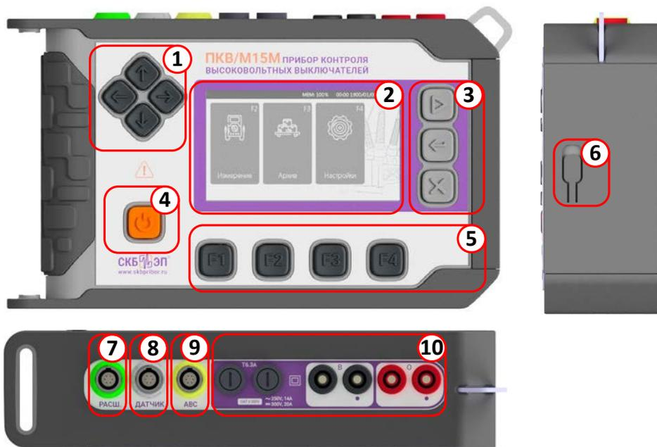
Рисунок 1 – Расположение разъемов и органов управления
